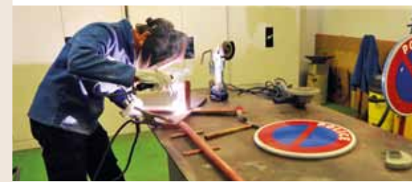
L'entretien des panneaux de signalisation mobiles s'effectue notamment à l'aide de travaux de soudure.
